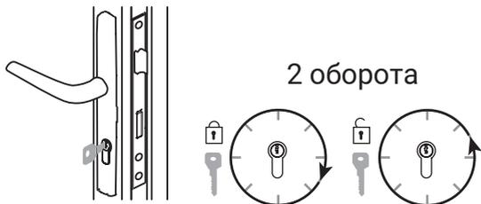
В закрытом положении поверните ключ на 2 полных оборота по часовой стрелке после чего произойдет запирание во всех точках. Чтобы отпереть дверь, поверните ключ на 2 полных оборота против часовой стрелки.
