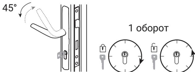
В закрытом положении необходимо поднять ручку вверх на  $45^\circ$ , вернуть ее обратно в горизонтальное положение, а затем повернуть ключ по часовой стрелке.
