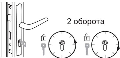
В закрытом положении поверните ключ на 2 полных оборота против часовой стрелки после чего произойдет запирание во всех точках. Чтобы отпереть дверь, поверните ключ на 2 полных оборота по часовой стрелке.
