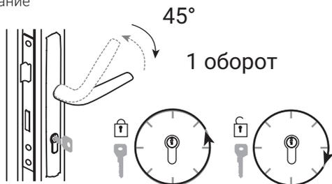
В закрытом положении необходимо поднять ручку вверх на  $45^\circ$ , вернуть ее обратно в горизонтальное положение, а затем повернуть ключ против часовой стрелки.
